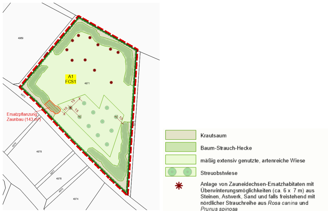
Abb. 15: Ausgleichskonzept der Ausgleichsmaßnahme A1 mit Legende (ohne Maßstab)
